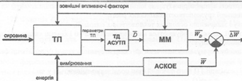
Рис. 1. Узагальнена структурна схема системи контролю ефективності використання енергетичних ресурсів на промисловому підприємстві
