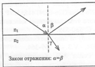
Рис. 1. Отражение и преломление луча света на границе двух сред с различными значениями оптической плотности
